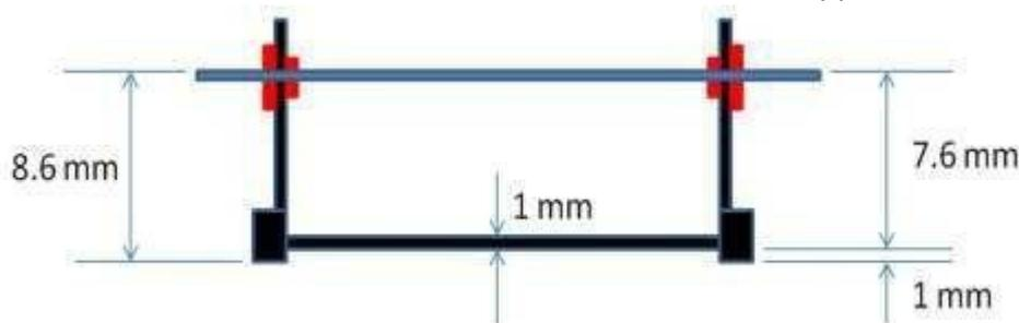
*Data l'introduzione del motore brushless (VEDI SEZ. MOTORE) sarà consentito applicare ai telai omologati per motori tradizionali, mediante saldatura sulla colonnina porta cuscinetto esistente, una apposita piastrina **aggiuntiva** alla quale si potrà avvitare tale Motore.*
